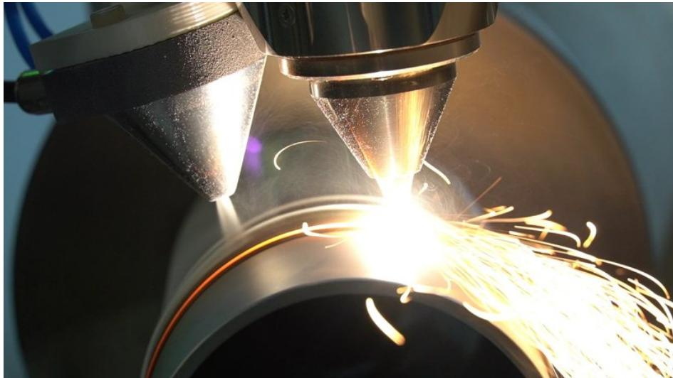
Ein neues Laserkombinationsverfahren ermöglicht PFAS-freie Verbundschichten aus Metall und dem Hochleistungskunststoff PEEK für zusätzliche Anti-Haft-, Gleit- oder Korrosionsschutzfunktionen auf Metallbauteilen (Bild: Fraunhofer ILT).
