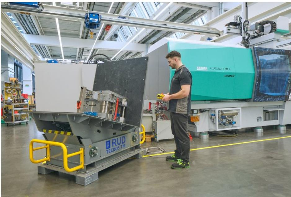
Der Wendetisch wird im Kundencenter am Hauptsitz in Loßburg für Werkzeugtests und Turnkey-Projekte eingesetzt (Bild: Ingo Jensen/RUD).
