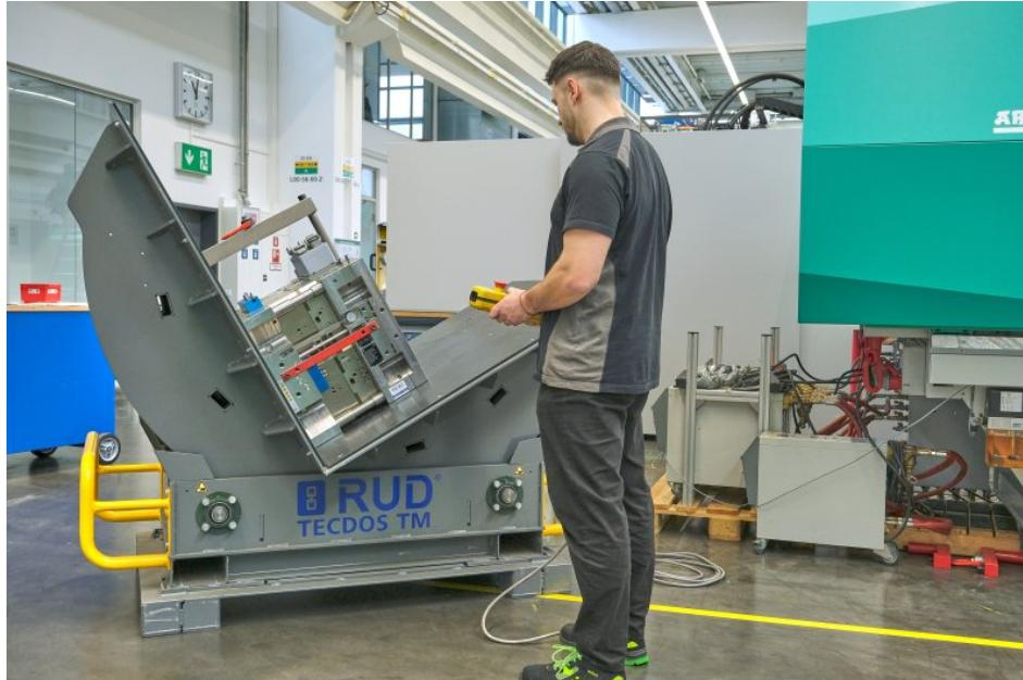
Tonnenschwere Werkzeuge in Sekundenschnelle per Knopfdruck wenden: Nur eine Person bedient den »Tecdos TM« (Bild: Ingo Jensen/RUD).
