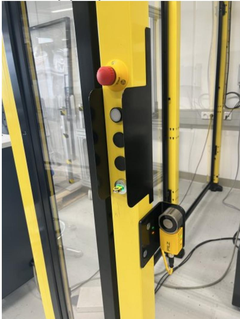
Das Zugangsberechtigungssystem »PITreader« entscheidet anhand der auf dem Schlüssel gespeicherten Berechtigungen, wer Zugang zur Anwendung erhält. Die elektromagnetische Sicherheitszuhaltung »PSENslock« (rechts) sorgt für die sichere Türzuhaltung (Bild: Schüco International KG).
