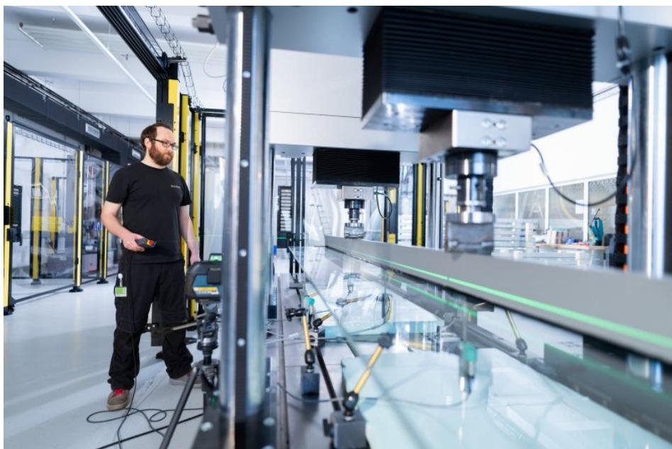
Prüfstempel setzen ein Fensterelement im Prüfzentrum von Schüco unter Druck. Je nach Zugangs- und Berechtigungslevel kann der Bediener bei Stillstand der Anlage eintreten und auf die Applikationen zugreifen (Bild: Pilz/Frank Peterschröder).
