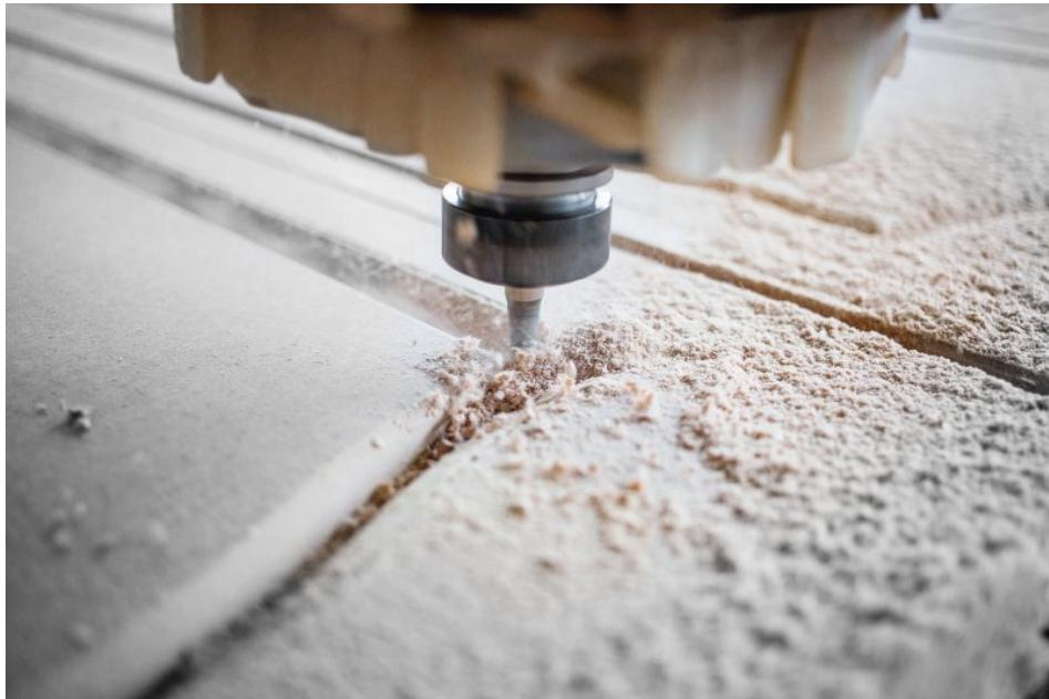
Frässtifte eignen sich für das Fräsen, Sägen und Bohren von Kunststoffen und Composites (Bild: Lukas-Erzett).
