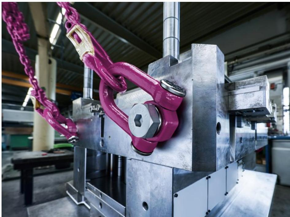
Der Anschlag- und Zurrpunkt mit Federmechanik erhöht die Sicherheit in der Spritzgießfertigung (Bild: RUD).
