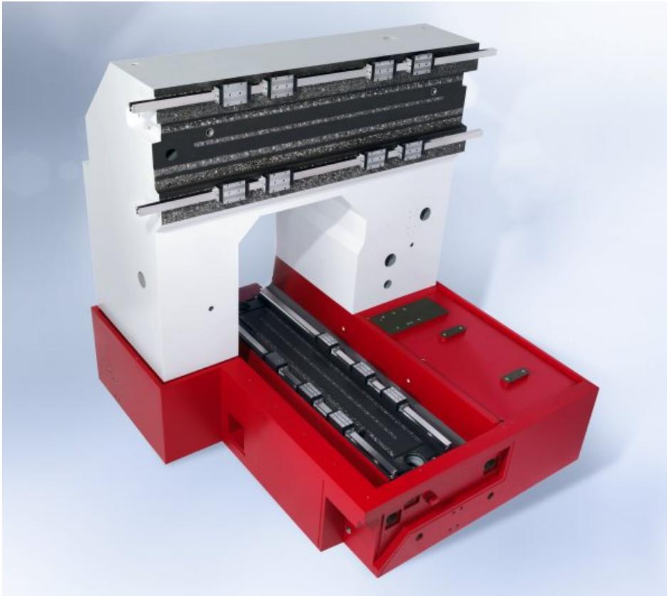
Mineralguss ist ein ideales Material für Maschinenbetten. Die hohe Schwingungsdämpfung trägt zur Erhöhung der Bearbeitungsgenauigkeit, zur Verbesserung der Oberflächenqualität und zur Verlängerung der Standzeiten bei (Bild: Rampf).
