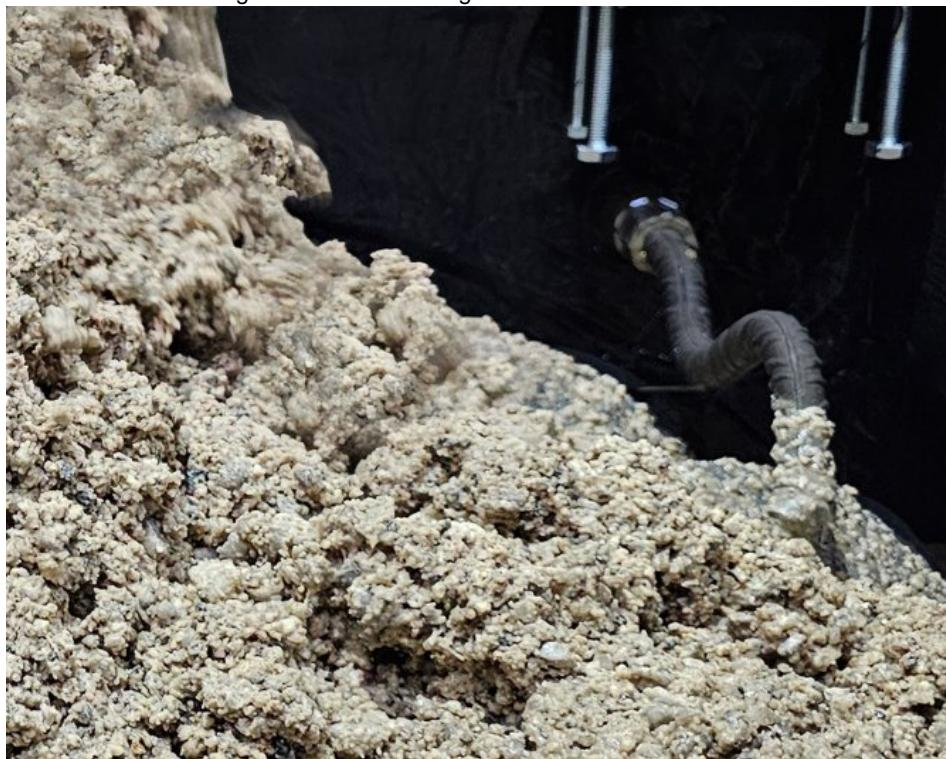
Mineralguss von Rampf besteht zu über 90 Prozent aus natürlichen Mineralien und Gesteinen sowie einem Bindemittel auf Epoxidharzbasis. Der Werkstoff kann als Bauschutt entsorgt sowie recycelt werden – nach neuesten Erkenntnissen auch für die Herstellung neuer Maschinenbetten (Bild: Rampf).
