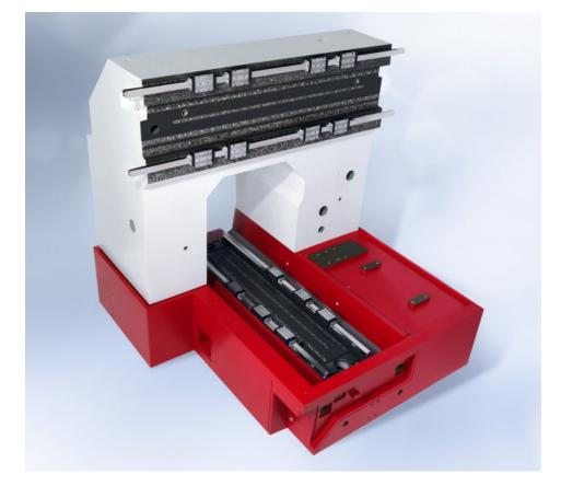
Mineralguss ist ein ideales Material für Maschinenbetten. Die hohe Schwingungsdämpfung trägt zur Erhöhung der Bearbeitungsgenauigkeit, zur Verbesserung der Oberflächenqualität und zur Verlängerung der Standzeiten bei (Bild: Rampf).
