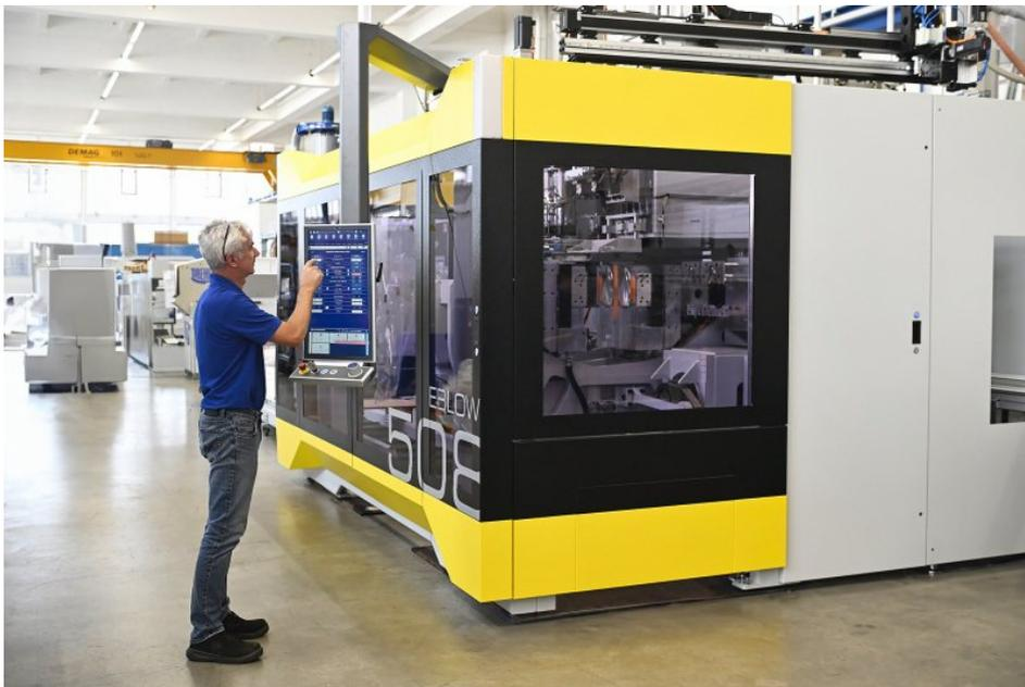
Auf dieser Extrusionsblasformmaschine wird eine Live-Demonstration mit glasklaren PET-Griffflaschen gezeigt (Bild: Bekum).
