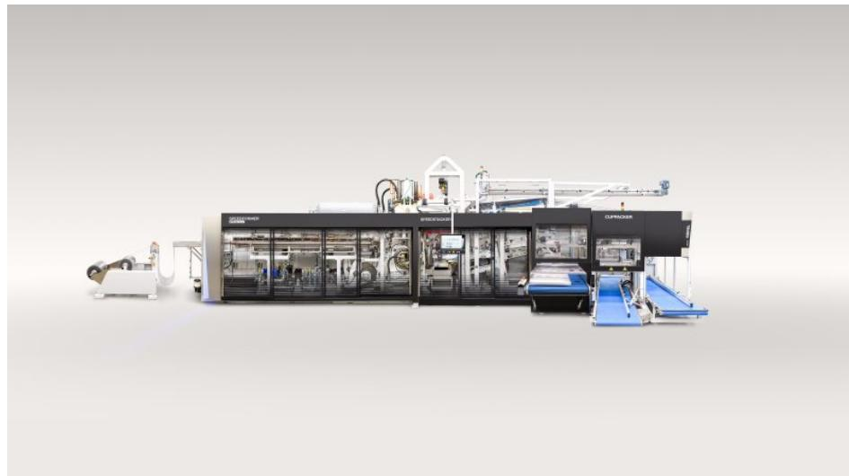
Der Thermoformer produziert hochwertige Becher aus rPET (Bild: Kiefel).
