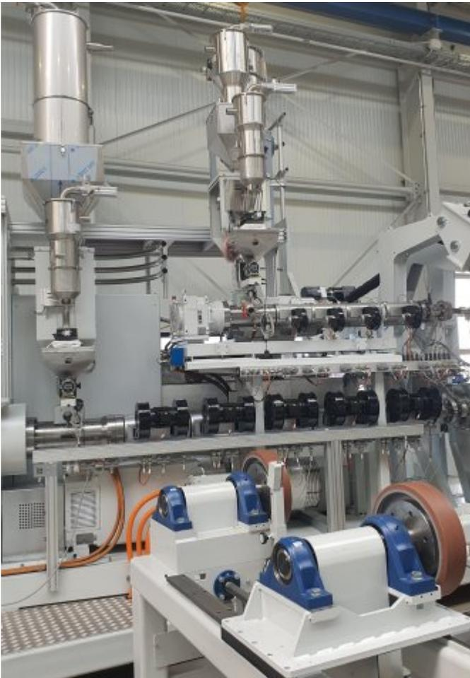
Das Herzstück der neuen Wickelrohranlage ist der optimierte Extruder mit Co-Extruder für mehrfarbige Wickelrohre (Bild: Boyke).
