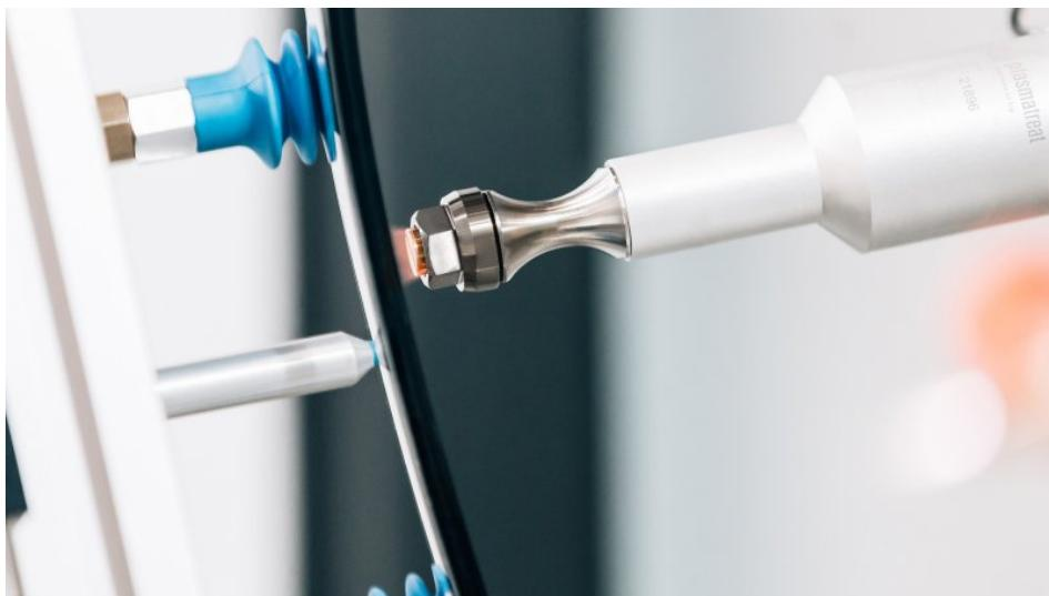
Die Plasmabehandlung ermöglicht primer- und chemiefreies Verkleben, Lackieren, Bedrucken und Abdichten (Bild: Plasmatreat).
