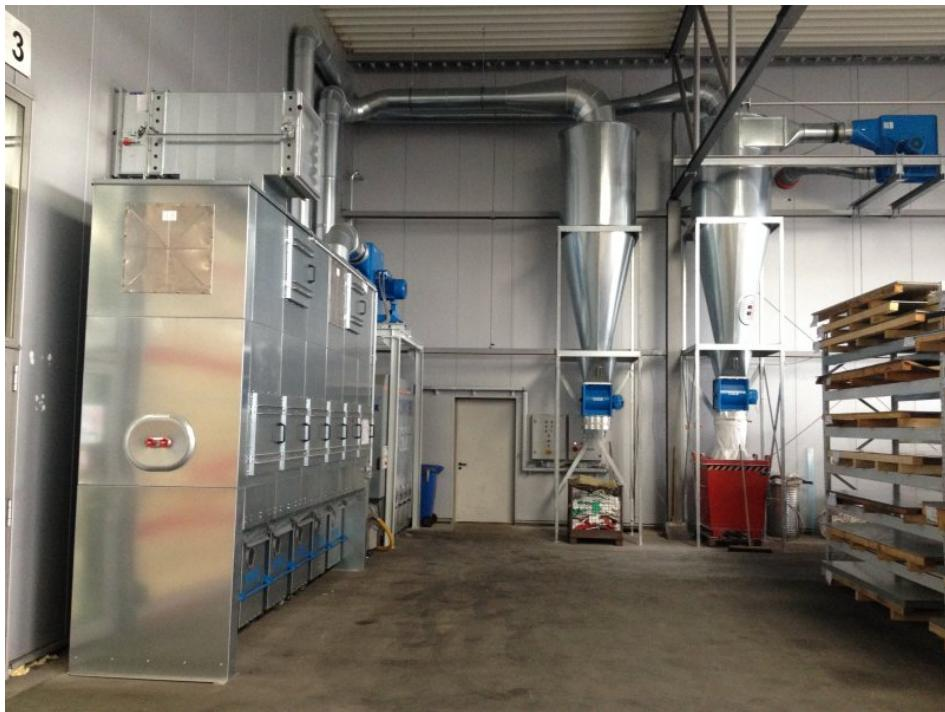
Filter- und Absaugtechnik mit Materialvorabscheidung trägt zur hohen Produktqualität in der Kunststoffindustrie bei (Bild: Nestro).
