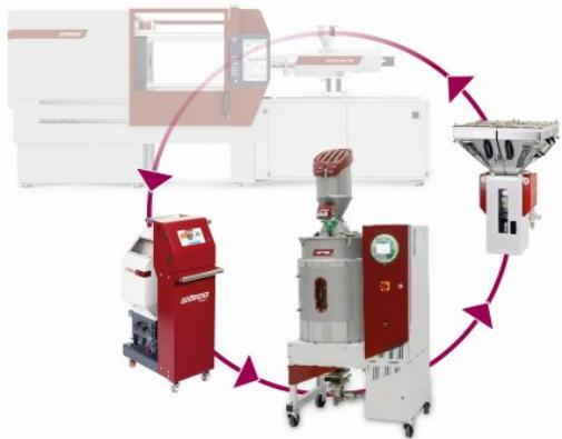
Inline-Recycling leicht gemacht – mit exakt aufeinander abgestimmten Systemlösungen (Bild: Wittmann).
