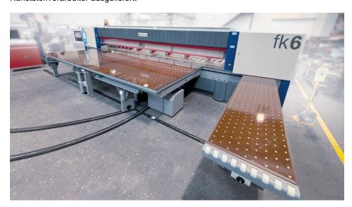
Die Plattenaufteilsäge ist für das Schneiden von Kunststoff- und Verbundplatten bis 120 mm Stärke ausgelegt (Bild: IMA Schelling).
