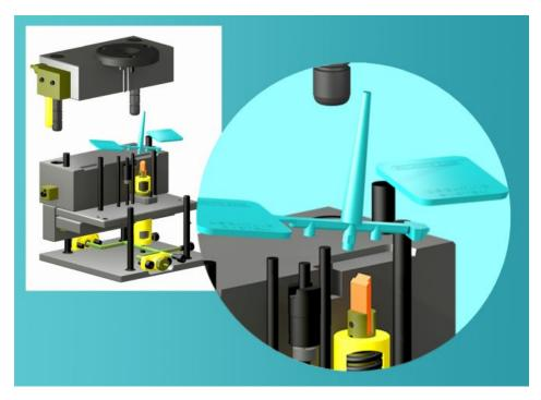
Das Cuttermesser trennt Angüsse während des Entformens automatisiert und präzise positioniert ab (Bild: i-mold).
