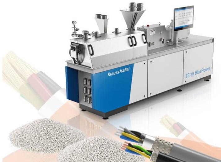
Der Extruder ist speziell für die Herstellung von HFFR-Kabelcompounds konfiguriert (Bild: Krauss-Maffei).
