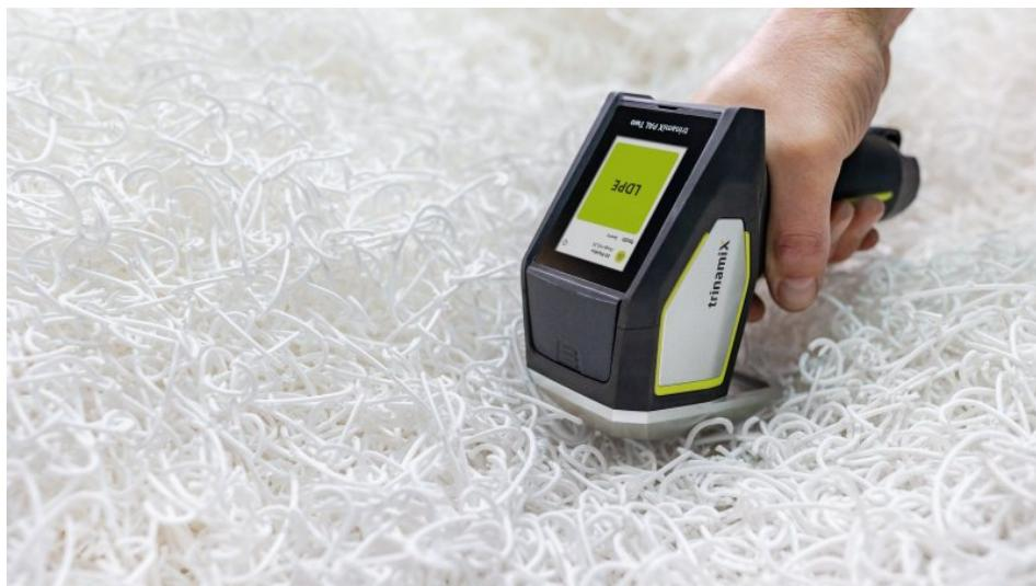
Das handliche Gerät dient der Materialanalyse in Produktions-, Sortier- und Recyclingprozessen (Bild: Trinamix).
