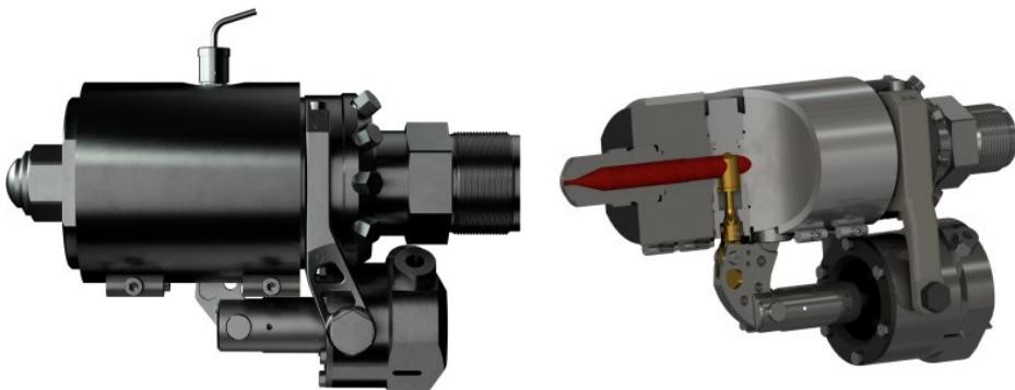
Mithilfe der Bolzenverschlussdüse mit Rückzug wird das kontrollierte Öffnen und Schließen des Kanals sichergestellt (Bild: herzog systems).
