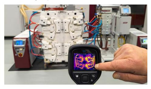
Das Assistenzsystem ist nur auf der rechten Werkzeughälfte aktiviert. Das Thermografiebild zeigt die homogene Wärmeverteilung und das schnellere Aufheizen (Bild: Wittmann).
