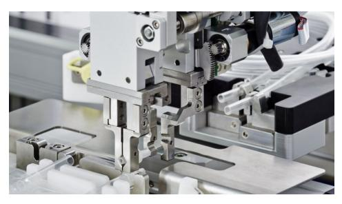
Die Montageanlage ist in unterschiedlichen Ausführungen erhältlich. Am hier abgebildeten Fügeprozess sind z. B. ein Zentrier- und ein Montagegreifer beteiligt (Bild: Knoll).
