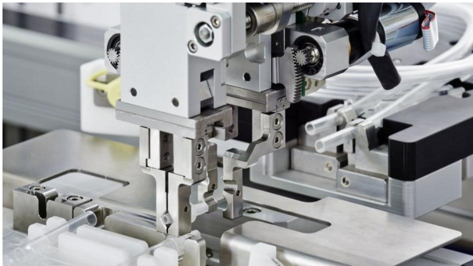
Die Montageanlage ist in unterschiedlichen Ausführungen erhältlich. Am hier abgebildeten Fügeprozess sind z. B. ein Zentrier- und ein Montagegreifer beteiligt (Bild: Knoll).
