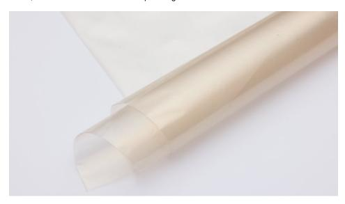
Das rLLDPE zielt auf Anwendungen ab, die eine sehr hohe Dehnbarkeit, einen geringen Gelanteil und ein ausgewogenes Verhältnis zwischen Zähigkeit und Steifigkeit erfordern (Bild: Borealis).
