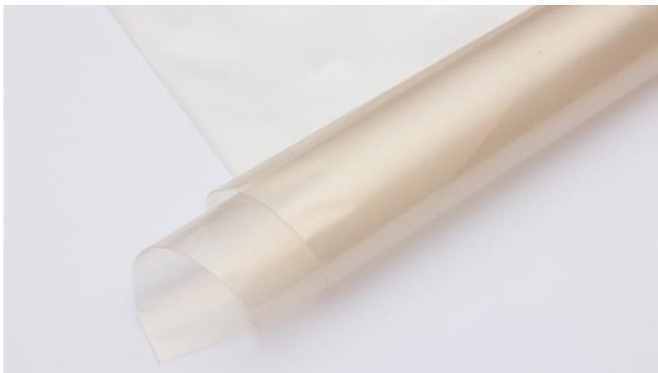
Das rLLDPE zielt auf Anwendungen ab, die eine sehr hohe Dehnbarkeit, einen geringen Gelanteil und ein ausgewogenes Verhältnis zwischen Zähigkeit und Steifigkeit erfordern (Bild: Borealis).
