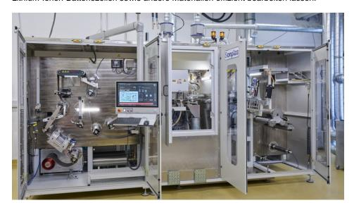
Präzise Folienbearbeitung: Die Anlage schneidet Batteriefolien im Rolle-zu-Rolle-Verfahren mittels Laser-Notching (Bild: Sonplas).
