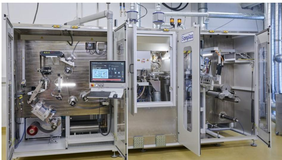
Präzise Folienbearbeitung: Die Anlage schneidet Batteriefolien im Rolle-zu-Rolle-Verfahren mittels Laser-Notching (Bild: Sonplas).
