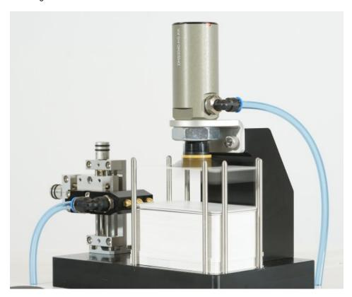
Mit den Vakuum-Hubsaugern lassen sich leichte Teile kostengünstig, sanft und schnell abstapeln und vereinzeln (Bild: MM Engineering).
