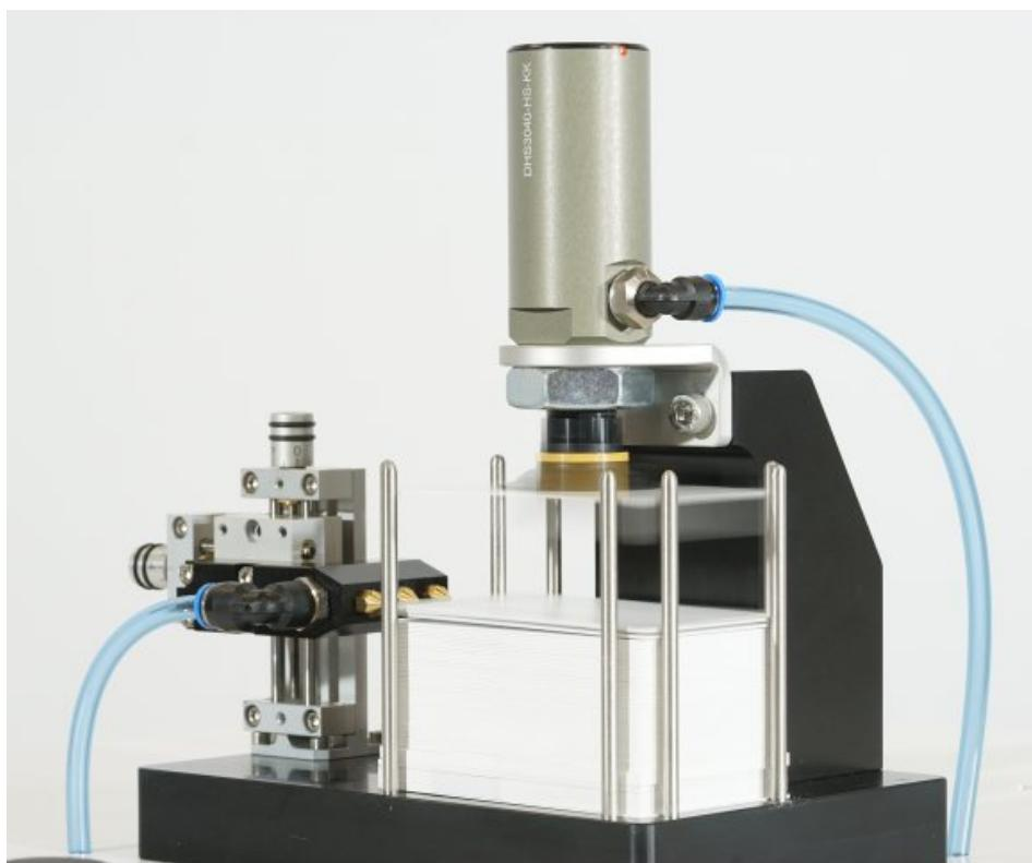
Mit den Vakuum-Hubsaugern lassen sich leichte Teile kostengünstig, sanft und schnell abstapeln und vereinzeln (Bild: MM Engineering).
