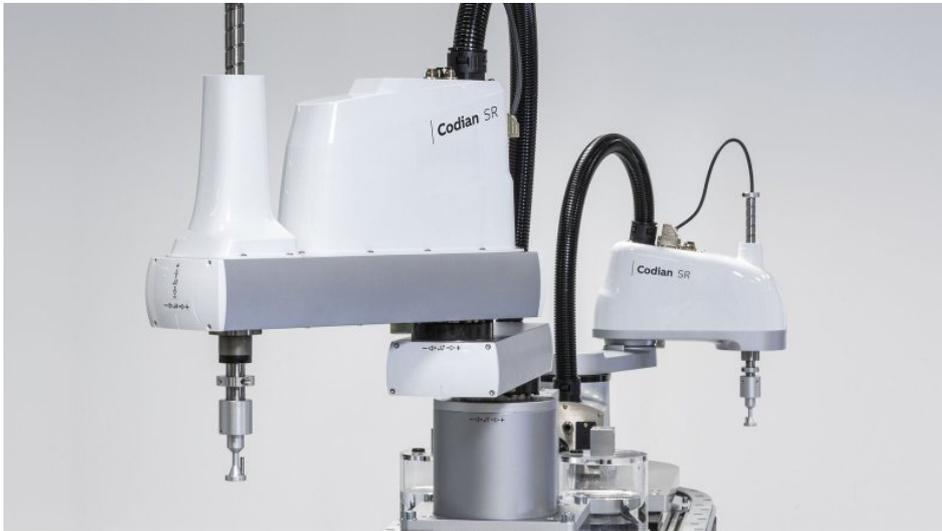
Die Scara-Roboter ermöglichen schnelle und präzise Bewegungen bei kompakten Abmessungen (Bild: B&R).
