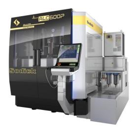
Erodiermaschine mit mit 8-Achsen-Simultansteuerung (Bild: Sodick).
