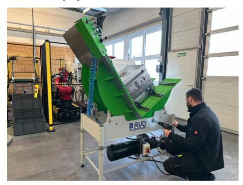
Die Wartungsstation erlaubt das einfache Handling der Spritzgießwerkzeuge (Bild: RUD).
