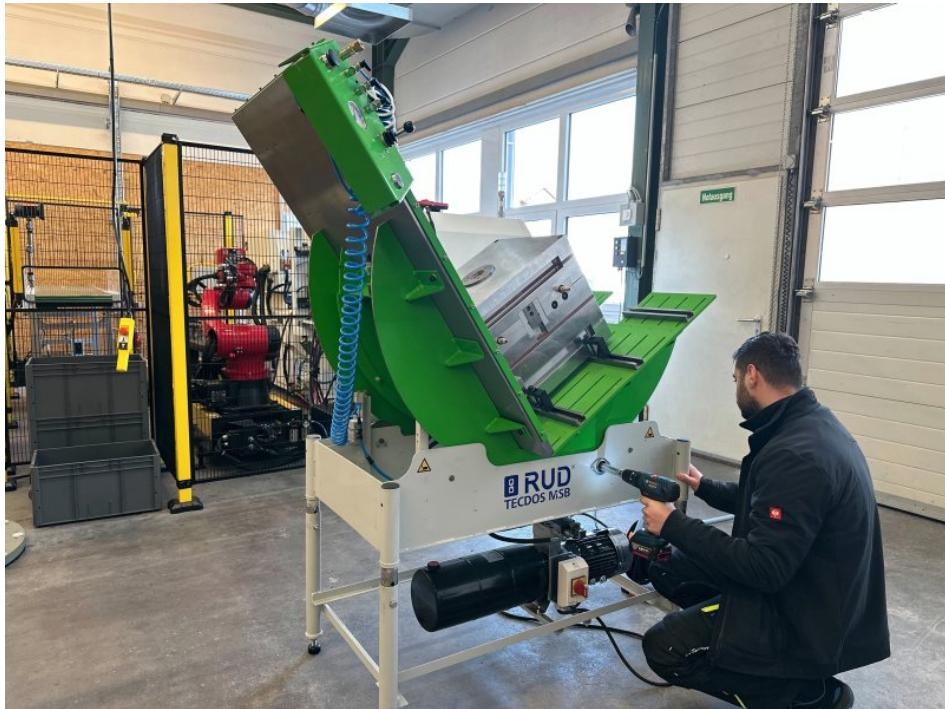
Die Wartungsstation erlaubt das einfache Handling der Spritzgießwerkzeuge (Bild: RUD).
