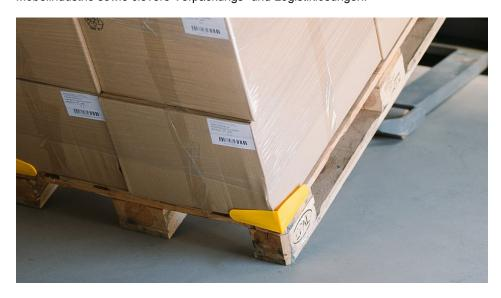
Die Gleitschutzecke wird zur Ladungssicherung verwendet (Bild: Böhl Kunststofftechnik).
