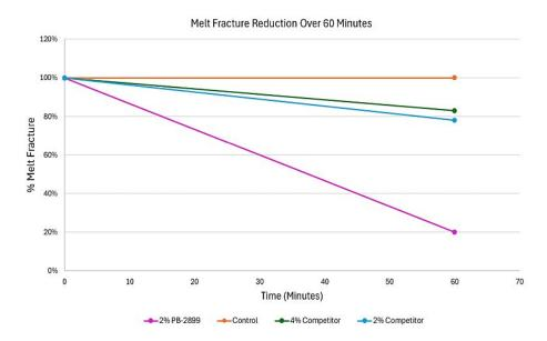
Das neue Masterbatch verbessert den Produktionsprozess, indem es Schmelzflussinstabilitäten wie Schmelzbrüche reduziert (Bild: Polyvel).
