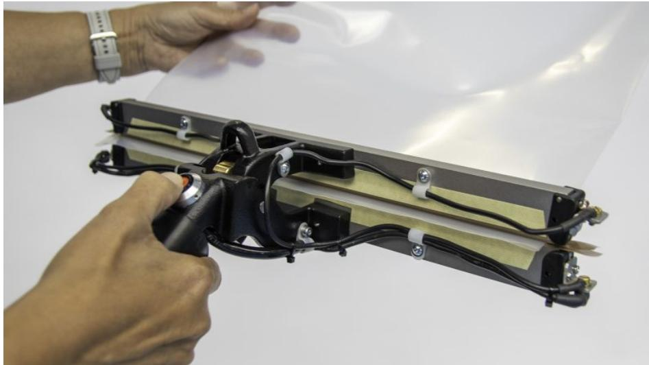
Mit der pneumatischen Folienschweißzange können Verpackungen per Knopfdruck verschweißt werden (Bild: joke mechanix GmbH).
