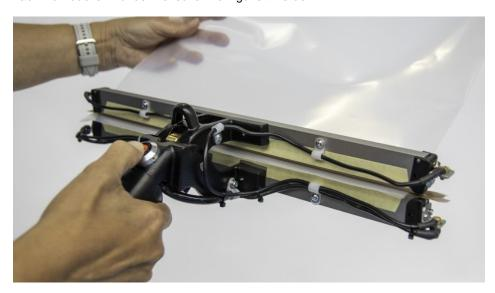
Mit der pneumatischen Folienschweißzange können Verpackungen per Knopfdruck verschweißt werden (Bild: joke mechanix GmbH).
