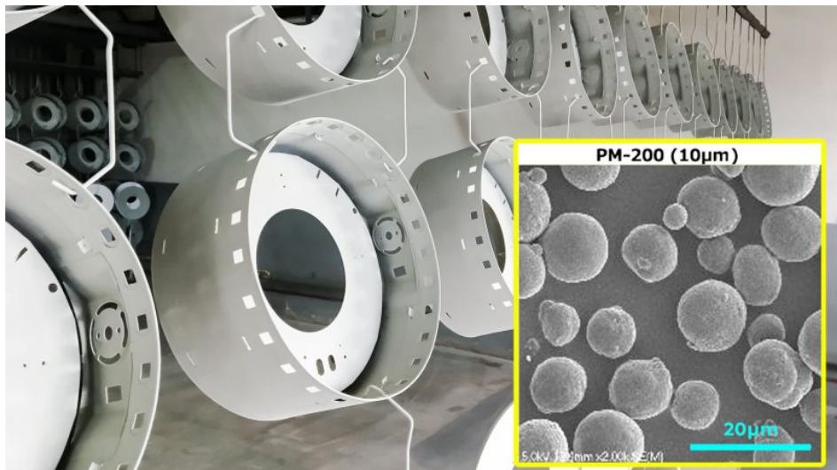
Elektrostatisch aufgebrachte Pulverbeschichtungen gehören zu den typischen Anwendungen, in denen das UHMW-PE-Feinpulver anstelle von PTFE eingesetzt wird (kleines Bild: Dreyplas, Hintergrundbild Alexander Lipko).
