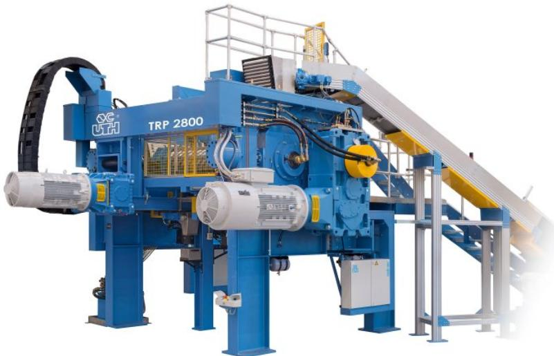
Zwei-Walzen-Plastifizierer mit integrierter Zahnradpumpe zur schonenden Verarbeitung und Homogenisierung von Kautschukmischungen (Bild: UTH).
