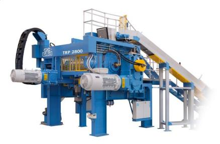
Zwei-Walzen-Plastifizierer mit integrierter Zahnradpumpe zur schonenden Verarbeitung und Homogenisierung von Kautschukmischungen (Bild: UTH).
