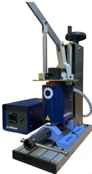
Neue Version der manuellen Spritzgießmaschine mit Handrad zur komfortablen Düsenhöhenverstellung (Bild: Eckloff).
