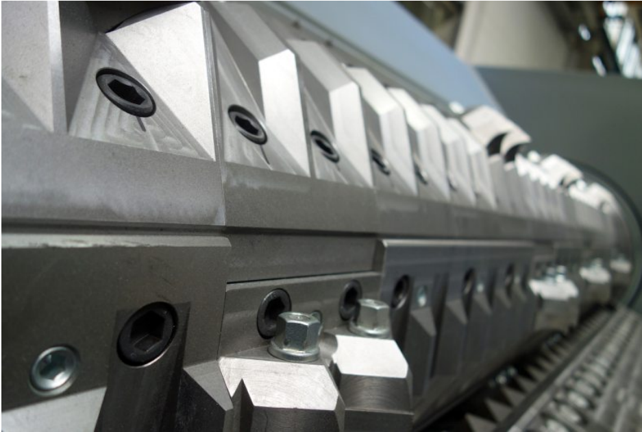
Rotor eines Einwellenshredders mit aufgeschraubten Messerkassetten (Bild: Herbold Meckesheim).
