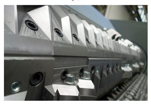
Rotor eines Einwellenshredders mit aufgeschraubten Messerkassetten (Bild: Herbold Meckesheim).
