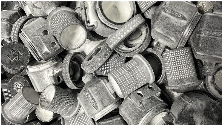
Mittels SAF-Technologie 3D-gedruckte Bauteile aus Polypropylen nach der Entpulverung mit der neu entwickelten Lösung (Bild: Stratasys).
