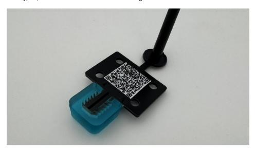
Kabelhalter-Clip, hergestellt mit dem »Hybrid Tooling«-Verfahren, bei dem nur der Bereich mit Hinterschnitt aufgelöst wird (Bild: SK Industriemodell).
