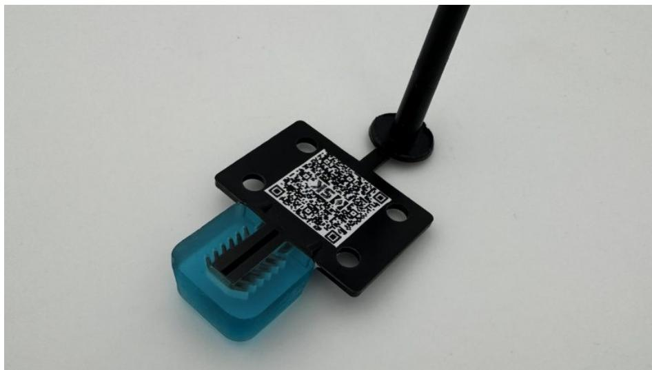
Kabelhalter-Clip, hergestellt mit dem »Hybrid Tooling«-Verfahren, bei dem nur der Bereich mit Hinterschnitt aufgelöst wird (Bild: SK Industriemodell).
