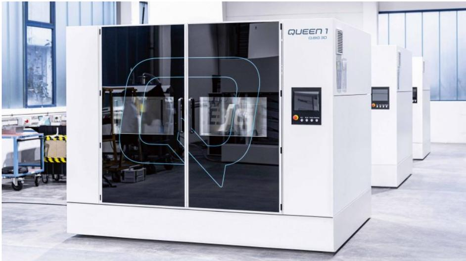
Anlage für XXL-Anwendungen im 3D-Extrusionsdruck (Bild: Q.Big 3D).
