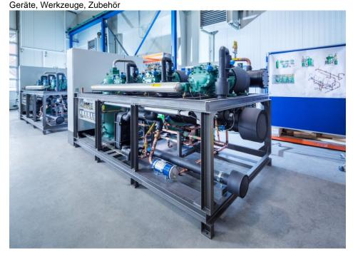
Die »Ecopro 2.0«-Serie von L&R zeichnet sich durch hohe Energieeffizienz aus und wurde für den Betrieb mit alternativen HFO-Kältemitteln entwickelt. Bild: L&R
