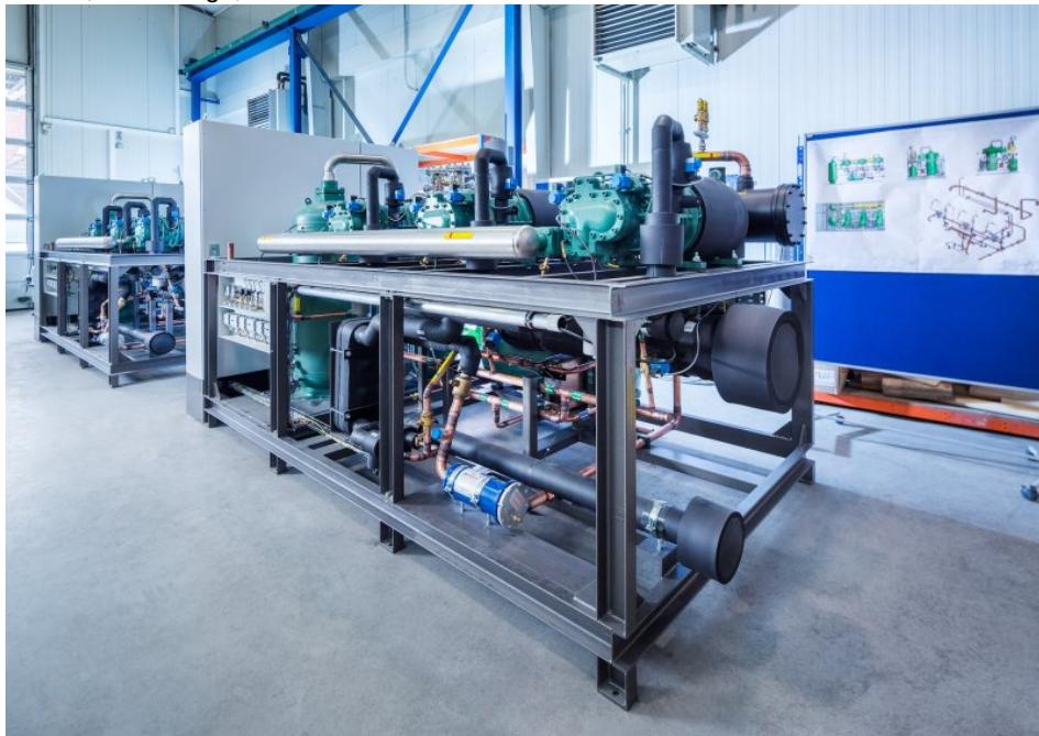
Die »Ecopro 2.0«-Serie von L&R zeichnet sich durch hohe Energieeffizienz aus und wurde für den Betrieb mit alternativen HFO-Kältemitteln entwickelt. Bild: L&R
