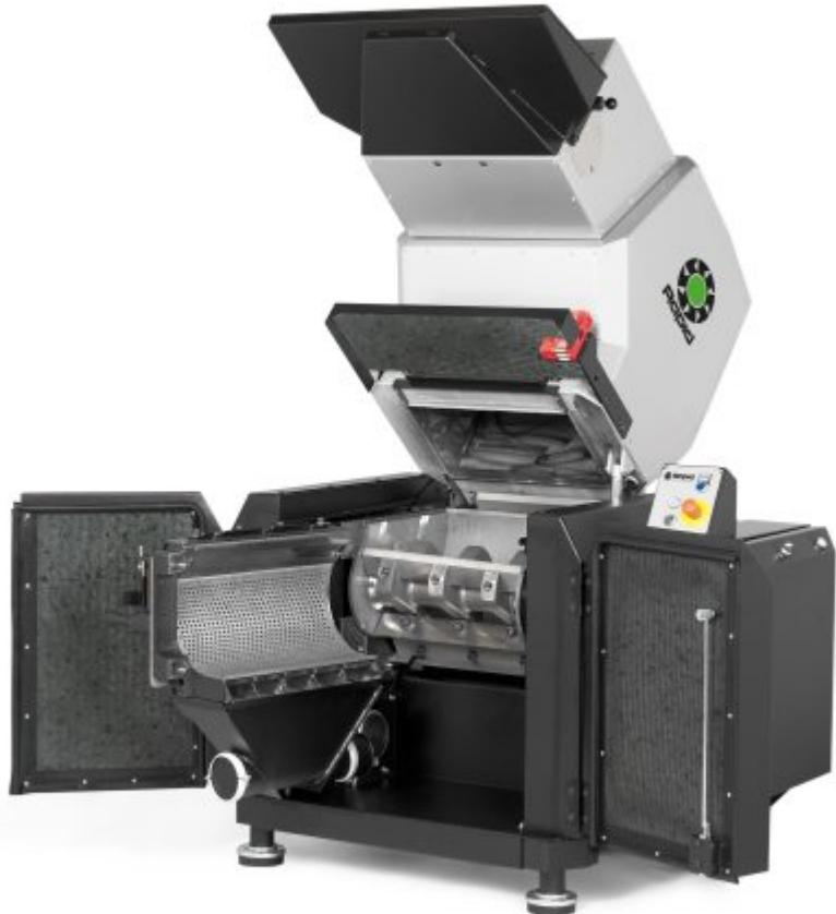
Die Schneidmühle kann als Zentralmühle oder als Inline-Mühle eingesetzt werden
