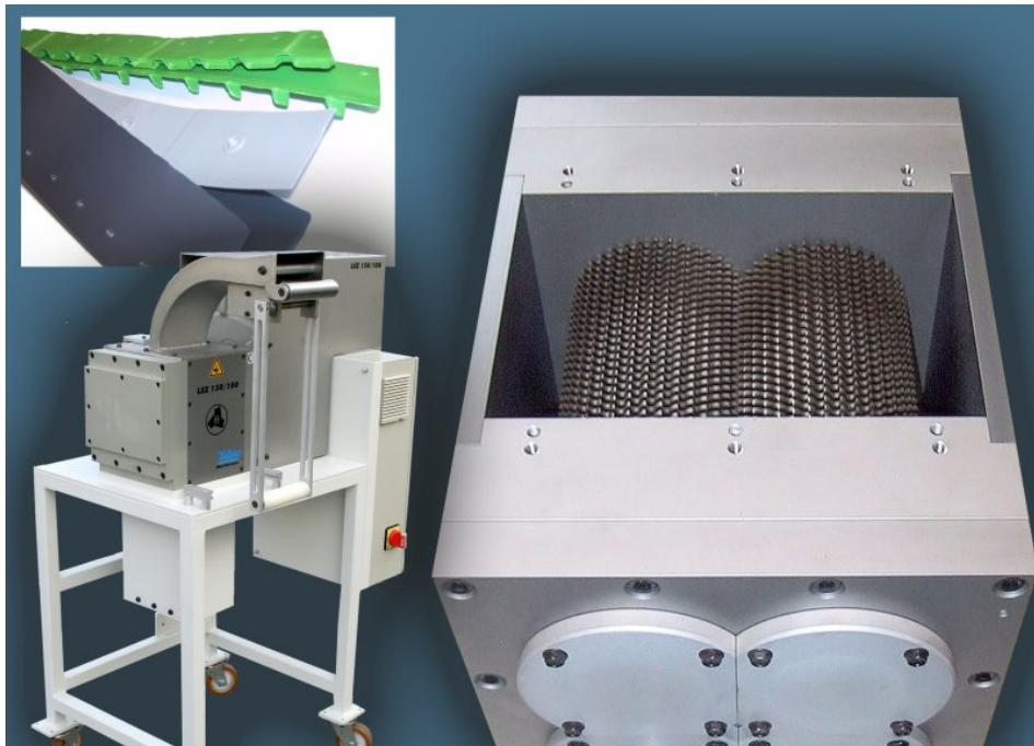
Vier paarweise übereinander angeordnete Zahnwalzen aus gehärtetem Werkzeugstahl ziehen auch stark profilierte Randstreifen sicher ein und zerkleinern sie in einem Schritt (Bild: Hellweg).
