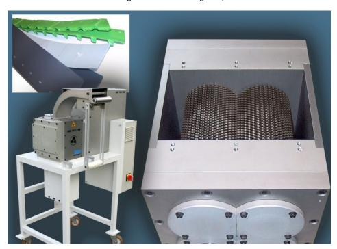
Vier paarweise übereinander angeordnete Zahnwalzen aus gehärtetem Werkzeugstahl ziehen auch stark profilierte Randstreifen sicher ein und zerkleinern sie in einem Schritt (Bild: Hellweg).
