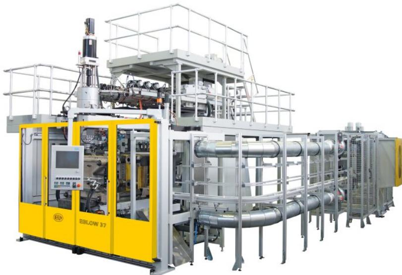
Die »Eblow 37« von BEKUM kann viele blasfähige Materialien von HDPE und PP in Mono- und Mehrschichtausführung bis zu Polycarbonat verarbeiten.
