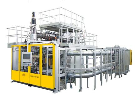
Die »Eblow 37« von BEKUM kann viele blasfähige Materialien von HDPE und PP in Mono- und Mehrschichtausführung bis zu Polycarbonat verarbeiten.
