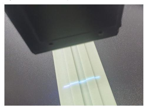
Anwendungsbeispiel für die kontinuierliche Inline-Laserüberwachung (Bild: K-Profile).
