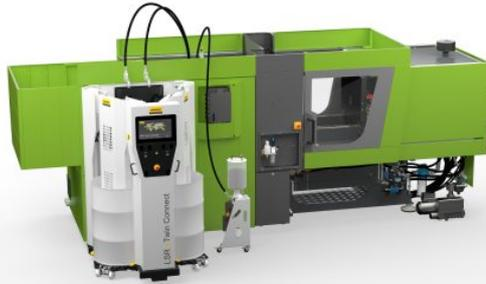
Holmlose und energiesparende Spritzgießmaschine, optimiert für Flüssigsilikon-Anwendungen (Bild: Engel).
