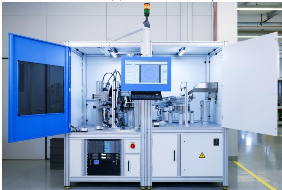
Das System für optische Qualitätsprüfung beim Spritzgießen bietet eine präzise 100%-Prüfung durch variable Kamerasyteme und KI-basierte Anomaliedetektion (Bild: Kistler).
