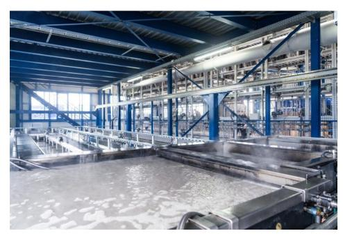
Verschmutzte Filter werden umweltgerecht in der vollautomatischen Waschanlage gereinigt. Mit der kombinierten Wasserbad- und Ultraschallreinigung sind 90 Prozent der Filter nach einmaliger Anwendung bereits vollständig gesäubert (Bild: Büchel).
