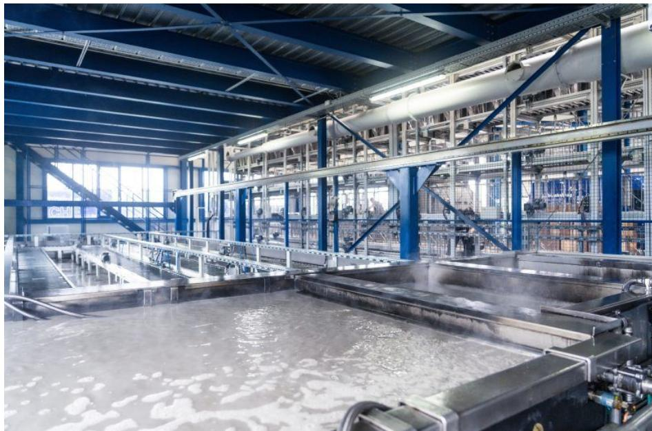
Verschmutzte Filter werden umweltgerecht in der vollautomatischen Waschanlage gereinigt. Mit der kombinierten Wasserbad- und Ultraschallreinigung sind 90 Prozent der Filter nach einmaliger Anwendung bereits vollständig gesäubert (Bild: Büchel).
