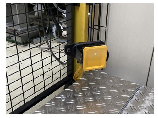
Im Bild einer von drei sicheren Radarsensoren. Mit seiner dreidimensionalen Bereichserfassung detektiert er Bewegungen im Schutzraum (Bild: Weidplas).
