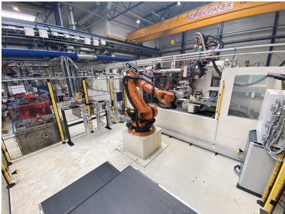
Sicher im Schutzraum dank Radarlösung: Roboter am Entnahmebereich der Spritzgießmaschine, im Vordergrund das Transportband (Bild: Weidplas).
