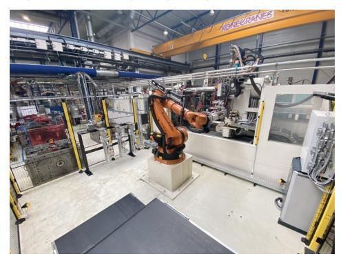
Sicher im Schutzraum dank Radarlösung: Roboter am Entnahmebereich der Spritzgießmaschine, im Vordergrund das Transportband (Bild: Weidplas).
