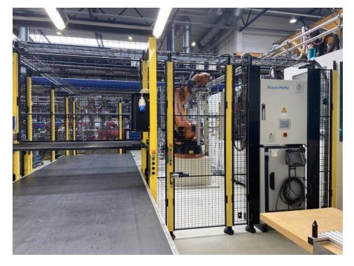
Bei Zutritt sicherer Halt: Rechts die durch Pilz gesicherte Roboterzelle bei Weidplas, links das Transportband (Bild: Weidplas).
