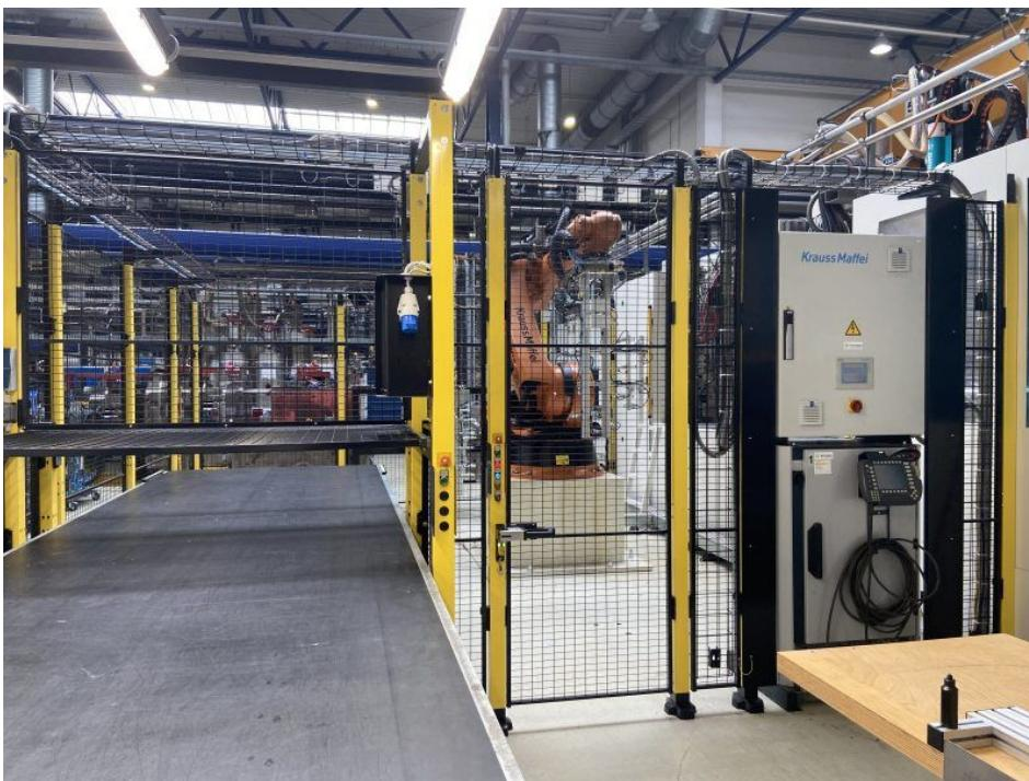
Bei Zutritt sicherer Halt: Rechts die durch Pilz gesicherte Roboterzelle bei Weidplas, links das Transportband (Bild: Weidplas).
