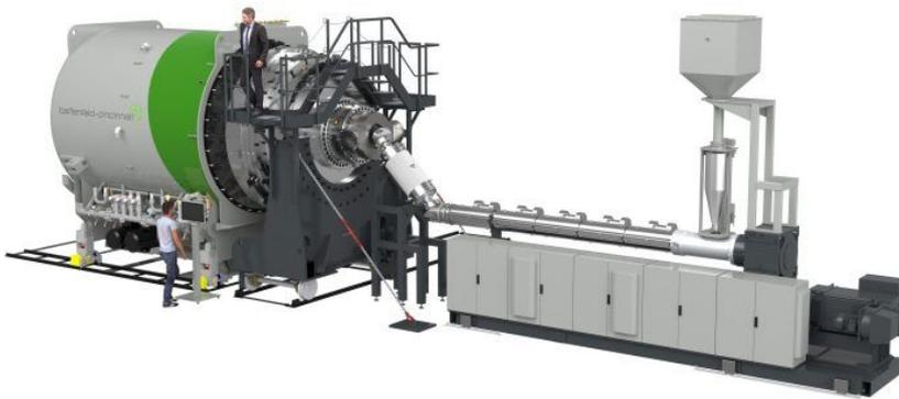
Mit diesem Rohrextruder lassen sich Kunststoffrohre bis 2,7 Meter Durchmesser fertigen (Bild: battenfeld-cincinnati).
