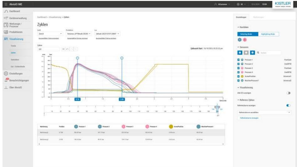
Über die webbasierte Schnittstelle lassen sich Maschinen und Prozessüberwachungssysteme synchron und zyklusübergreifend überwachen (Bild: Kistler).
