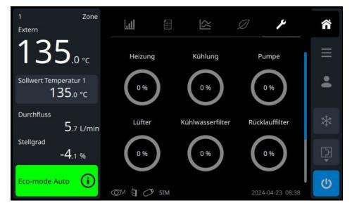
Das Dashboard informiert schnell über den Wartungsstatus der einzelnen Komponenten (Bild: HB-Therm).
