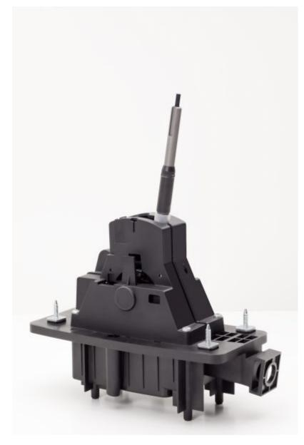
Schaltgehäuse aus 14 Kunststoffteilen (Bild: Weiss).
