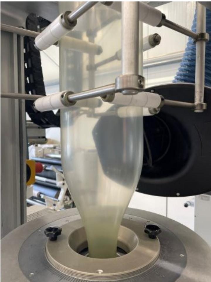
Folie aus Post-Consumer-Rezyklat in der Blasfolienanlage des Technikums der Firma Polifilm (Bild: APK).
