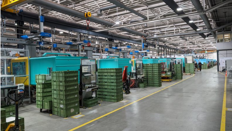
62 Spritzgießmaschinen fertigen im Hansgrohe-Werk die Produkte (Bild: Kuhn Fachverlag).
